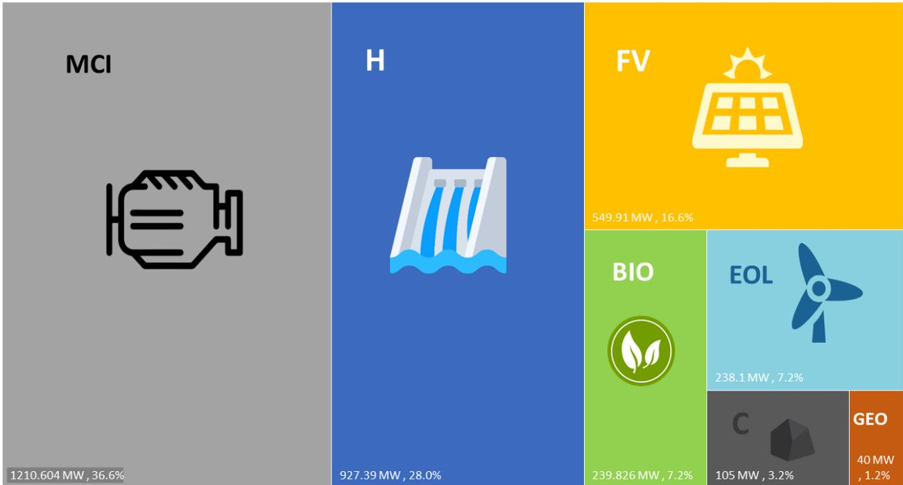
Ilustración 5 - Potencia eléctrica instalada 2024
